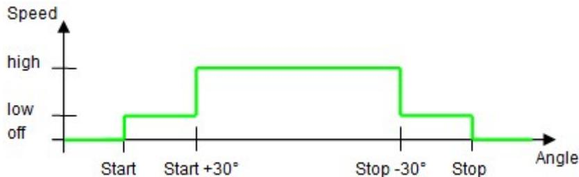
Die Rotoren von Yaesu/Kenpro erlauben eine 4-stufige Geschwindigkeitsregelung erlauben: 1 – 2 – 3 – 4, wobei 1 die niedrigste Geschwindigkeit ist und 4 die höchste.
