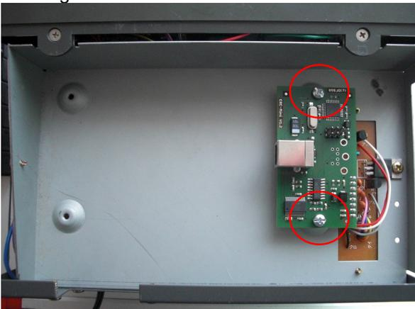
Stecken Sie den USB-B Anschluss in das ERC Mini SDX und lassen Sie das andere Ende aus der Rückseite des Gehäuses herauschauen.
