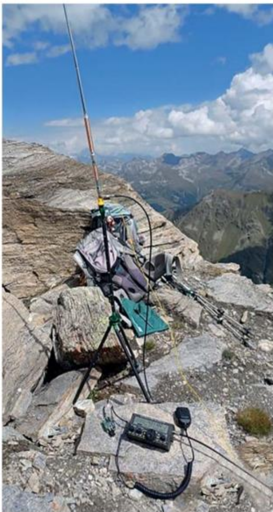
HB9NGB + HB9FZCs SOTA-Erfolgssetup: Elecraft KX2 mit AX1/AXE1-Teleskopantenne auf Cleverstick SOTA – „Wanderstock-Stativ“ und Original-Mik für SSB, sowie BaMaKey TP-III Taste für CW-Betrieb
