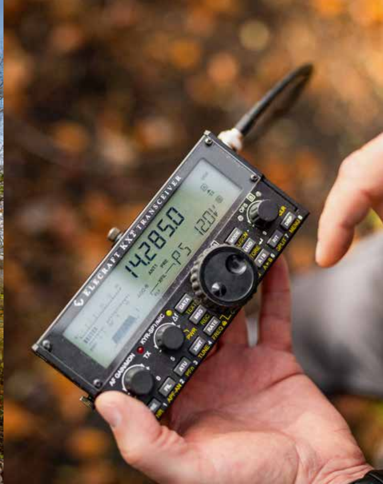
Funkamateure nennen ihr Gerät Transceiver, zusammengesetzt aus Transmitter (Sender) und Receiver (Empfänger).
