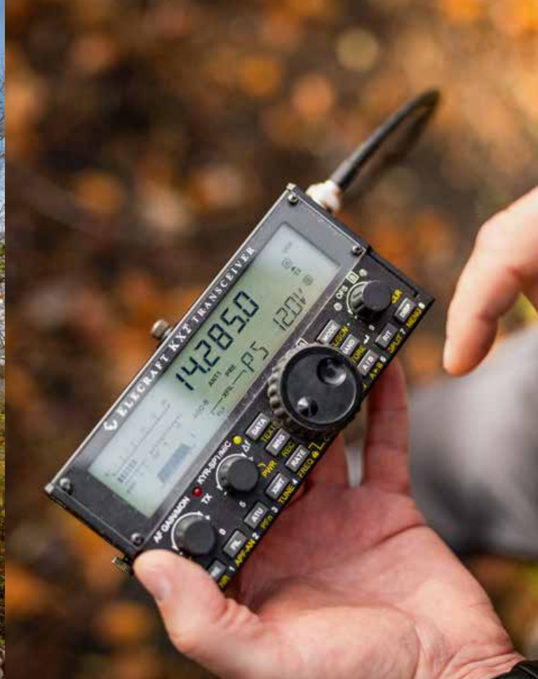
Les radioamateurs nomment leur radio «transceiver», appareil composé d'un émetteur (transmitter) et d'un récepteur (receiver).
